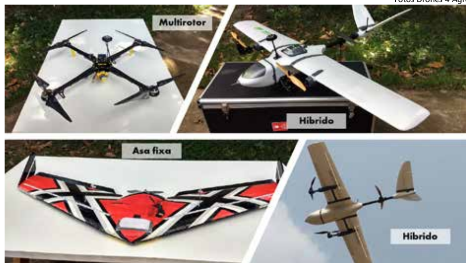
Tipos de drones existentes: multirrotor, asa fixa e híbrido
